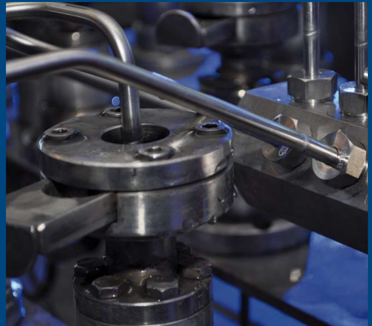
Hochdruckleitung auf dem Prüfstand / High-pressure pipe on test bench
