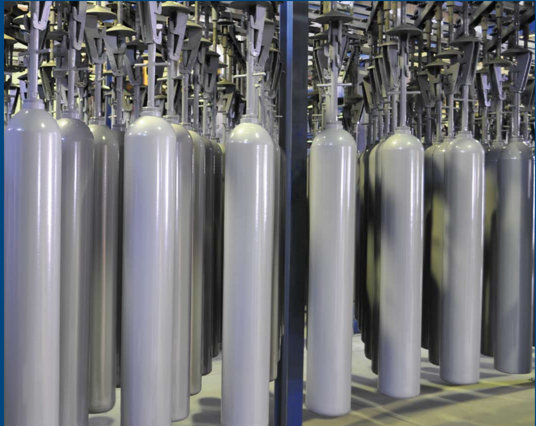
Korrosionsschutz durch Pulverbeschichtung / Corrosion protection with powder coating
